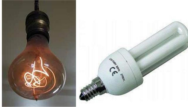
**La bombilla es un globo de cristal en el que se ha hecho el vacío y en cuyo interior se ha colocado un hilo de tungsteno por el que pasa una corriente eléctrica que se pone incandescente y sirve para alumbrar.**
